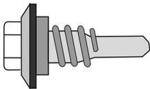
Tornillos de cuerpo cónico y punta fina. Ya sean taladrantes o roscantes, diseñados para fijar elementos de bajo calibre. También pueden ser utilizados para fijación en elementos de tipo ligero no estructurales. Debido a la naturaleza de este tipo de tornillos todo lo que se maneja en inventario es en la versión con arandela.
