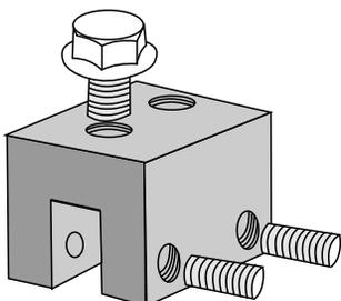
Abrazaderas S-5 disponibles para prácticamente cualquier perfil de Cubierta Metálica existente en el mercado, la Tecnología de la abrazadera S-5, implica agarrar el engargolado de tal manera que no hay penetración en la cubierta metálica utilizando, tornillos de fijación y Pernos que se hacen especialmente para los S-5.
